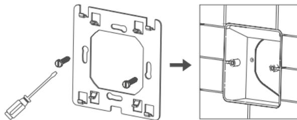
4 После подключения терморегулятора к проводам закрепите прибор на крепежной пластине (см. рис) оденьте лицевую панель и рамку.
